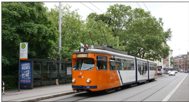
Mit dem Tw 516 war das gleichzeitig älteste und jüngste der drei Fahrzeuge im Einsatz. Geliefert wurde der Triebwagen 1964 als Gt 6 und unter Nummer 418 in Betrieb genommen. 1991 wurde er mit 15 weiteren Triebwagen durch Einfügen eines Niederflur-Mittelteils in den Gt 8 516 umgebaut. Nach einem Gastspiel in Gotha ist er seit 2022 wieder in Mannheim und seit 2023 wieder betriebsfähig.
