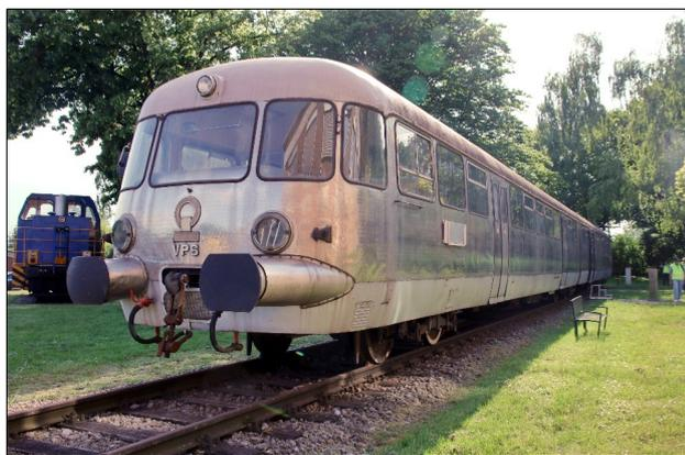
Bei dieser Gelegenheit wurde uns auch mit dem Hüttenflitzer ein ganz seltener Prototyp eines Nahverkehrstriebwagens mit Edelstahl-Außenhaut präsentiert, der 1957 von LHB entwickelt worden war und eine Alternative zum damals sehr populären Schienenbus sein sollte. Leider blieb es bei diesem Einzelstück, das bis 1975 im innerbetrieblichen Verkehr die
