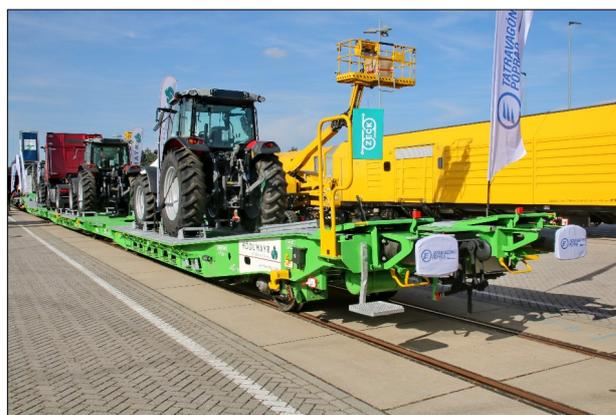
Neben den wenigen Reisezugwagen gab es eine Reihe von interessanten Spezialgüterwagen, die vor allem durch ihre Farbgebung und Bauart auffielen. So ein Schüttgutwagen mit hydraulischer Betätigung aller Klappen, dessen Bedienpult fast schon einem Führerstand glich. Genauso eindrucksvoll ist der 42,6 m lange, 3-teilige Niederdecker für den Transport von Zugmaschinen oder ähnlichem.
